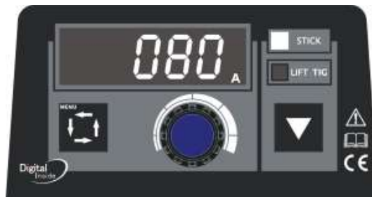
Рис 2: Интерфейс в режиме MMA
